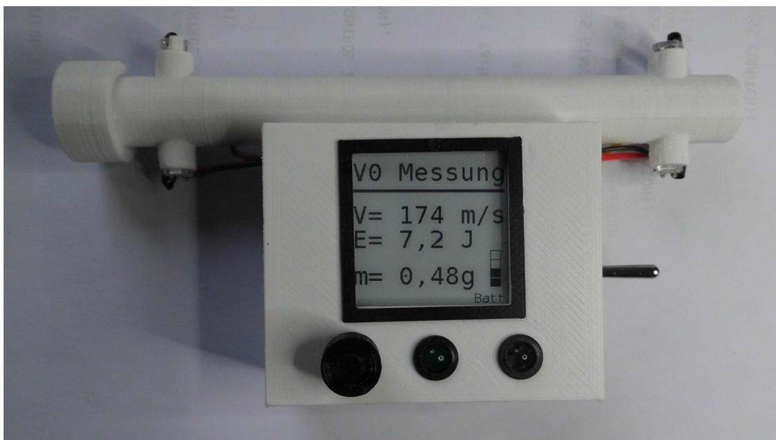
Das Gerät wurde entwickelt, um an einem alten (63 Jahre) Luftgewehr die Energie zu messen.
